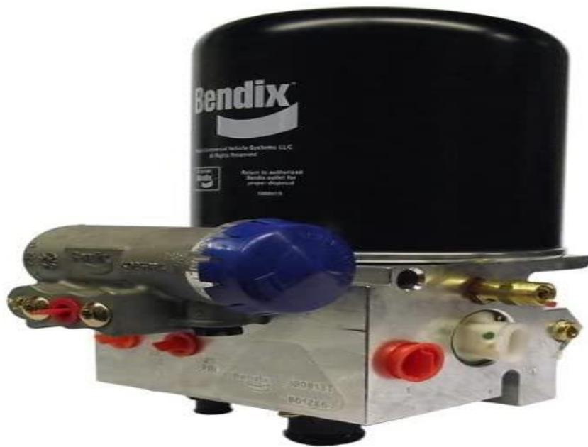
Para poder saber si el filtro secador de aire necesita ser reemplazado debe darse cuenta que en los tanques de aire pueda haber presencia de agua o aceite al momento de ser sangrados.
